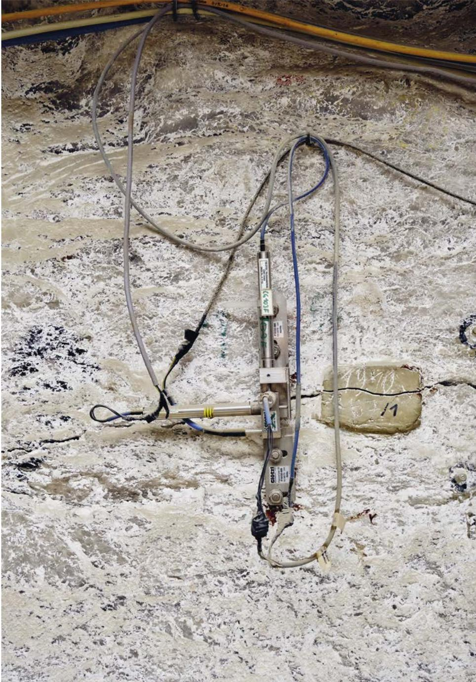
Am 19. Oktober 1967 mörtelte ein Markscheider im damaligen Salzbergwerk Morsleben ein Täfelchen aus Gips über einen feinen Riss. Irgendwann brach es entzwei und zeugt seither von den Bewegungen im Gestein. Heute wird der Riss an der Wand eines Stollens mit einem sogenannten Fissurometer überwacht. Er ist übrigens nicht Folge großräumiger geologischer Spannungen, sondern entstand lokal im Zuge des Streckenausbaus
