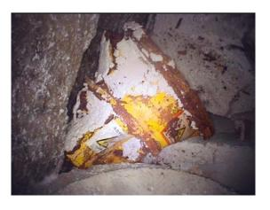
Im Sommer 2017 lieferte eine Kamera Bilder aus der Einlagerungskammer 7/750. Zu sehen ist eines der Fässer, das infolge des Jahrzehnte anhaltenden Gebirgsdrucks stark deformiert ist Drei Mann am Bohrgerät: Olaf Börner (links) koordiniert zusammen mit Bauleiter Dennis Dillge (Mitte) die Erkundungsarbeiten unter Tage. Ralf Speck ist für den Strahlenschutz verantwortlich
