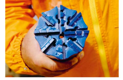
Mit rund hundert Umdrehungen pro Minute fräst sich der Bohrkopf ins Gestein. Dabei schafft er eine Strecke von bis zu zehn Zentimetern pro Minute
