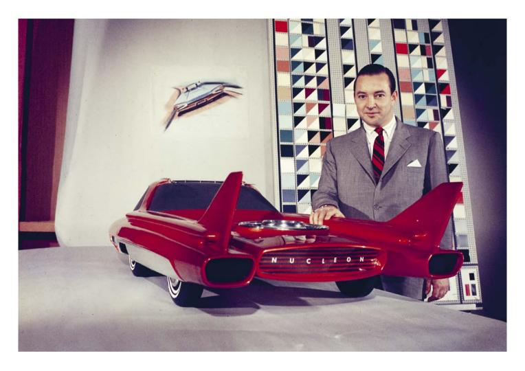
Bis zu 10 000 Kilometer mit einer "Tankfüllung" – das war der Traum von William Clay Ford (im Bild), dem Enkel des Automobilpioniers Henry Ford. Doch nicht mit Benzin sollte der 1958 als Modell vorgestellte Ford Nucleon fahren, sondern mit billiger Atomkraft. Die durch Kernspaltung in einem Miniaturreaktor erzeugte Wärme sollte über eine Dampfturbine das Fahrzeug antreiben. Die Idee passte in die Zeit – umgesetzt wurde sie zum Glück nie.
