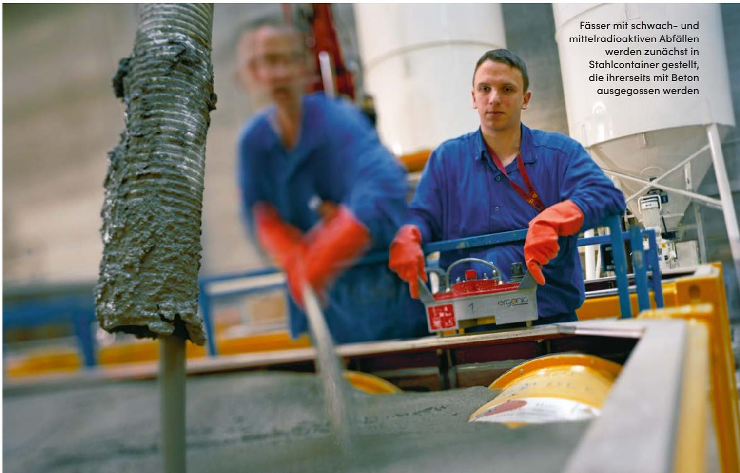
Fässer mit schwach- und mittelradioaktiven Abfällen werden zunächst in Stahlcontainer gestellt, die ihrerseits mit Beton ausgegossen werden
